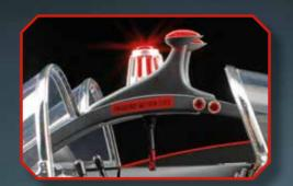
PALANCA DE GIRO DE EMERGENCIA para invertir la dirección del coche
