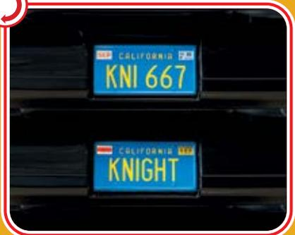
Um mecanismo giratório permite intercambiar as distintas chapas de matrícula.
